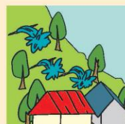
斜面から水が噴き出す。
