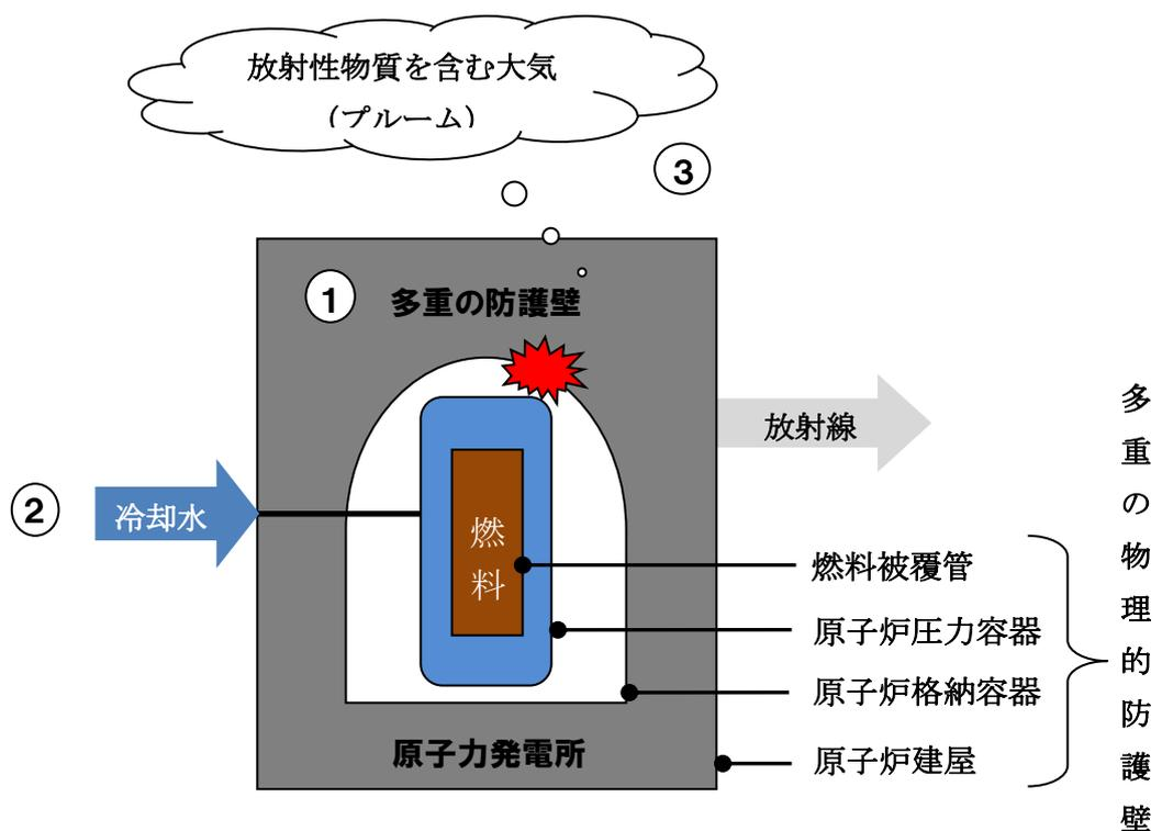
図 原子力発電所の事故の概要
