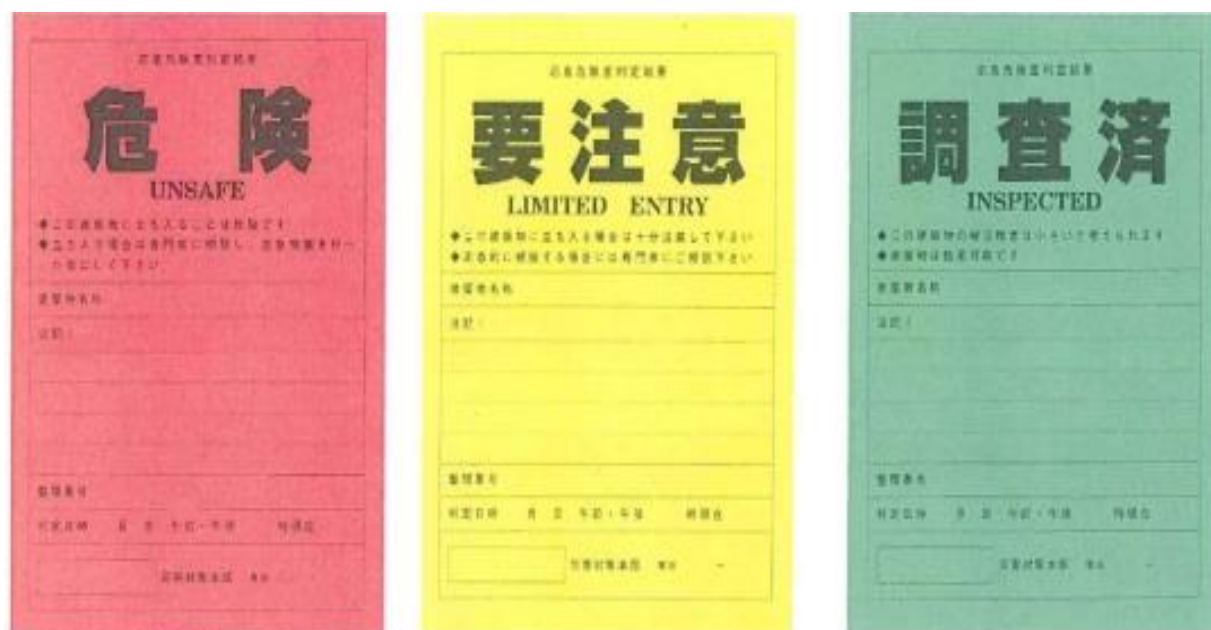
図 被災建築物応急危険度判定ステッカー
