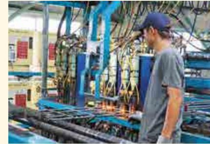
住宅基礎の金網溶接作業
