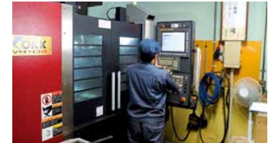
マシニングセンターによる部品製作
